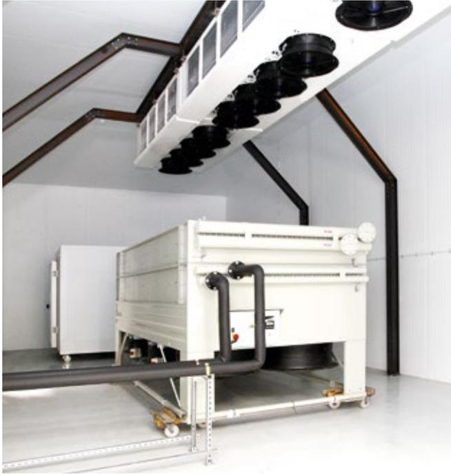
Unsere kalibrierte Leistungs-Prüfkammer, die Geräte von bis zu 12m Länge, 4m Höhe und 3m Breite aufnehmen kann, ermöglicht die Prüfung der größten Wärmetauscher.
