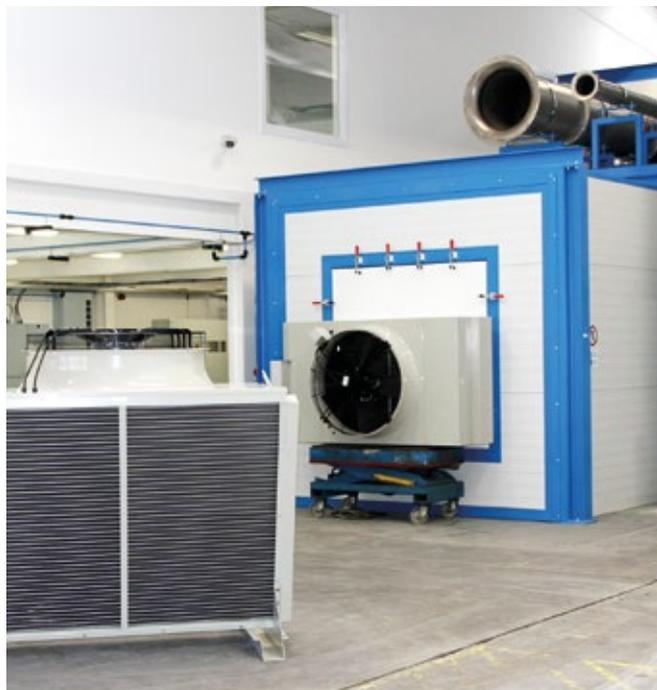
Die hauseigenen Windkanäle können Luftmengen von bis zu 50.000 m<sup>3</sup>/h testen; höhere Luftmengen werden aus Prüfungen mit Lüftern niedriger Drehzahlen ermittelt. Konventionelle Kältemittel lassen sich bis zu einer Nennleistung von 600 kW, Ammoniakkomponenten bis zu 120 kW und CO<sub>2</sub>-Komponenten bis zu einer Leistung von 150 kW prüfen; auch die Prüfung weiterer Kältemittel/-träger (synthetisch und natürlich) ist möglich.
