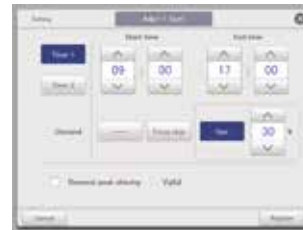
Bildschirmanzeige für Leistungsbegrenzung (Lastabwurf) des Außengeräts.
